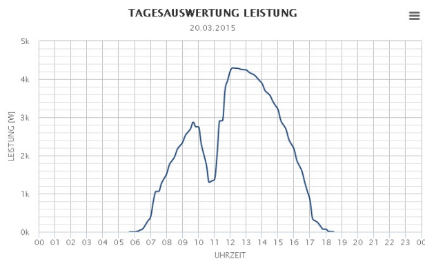
Abbildung 3: Einspeisung einer PV-Anlage in Niederösterreich, am 20. März 2014
