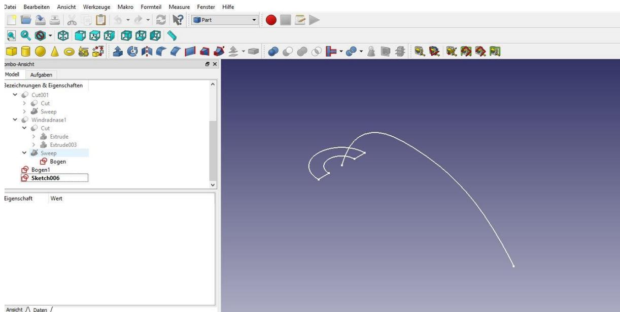
9: Im Sketcher Hilfskörper für die Abrundung erstellen. Den Halbrundbogen als Fläche definieren. Die Kurve von Punkt4 um 90 Grad drehen.
