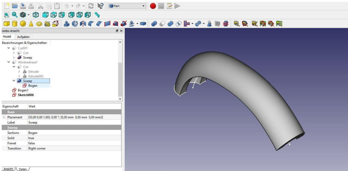
11 Dieser Volumenkörper vom Körper Punkt8 in Part – Boolesche Berechnung von 2 Festkörper positionieren und subtrahieren.
