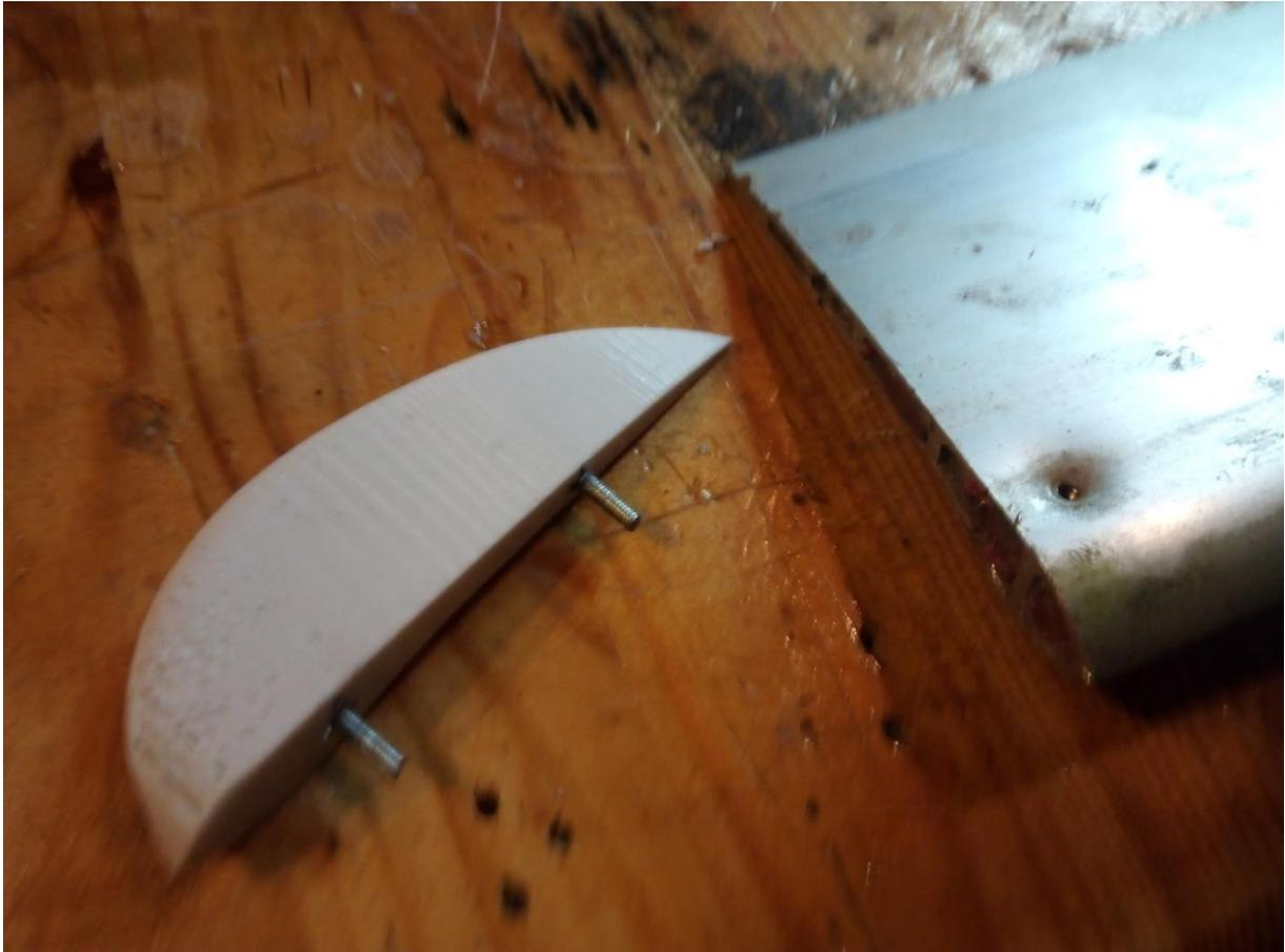
13 Gewindestange eingebohrt und mit 2K Kleber befestigt
