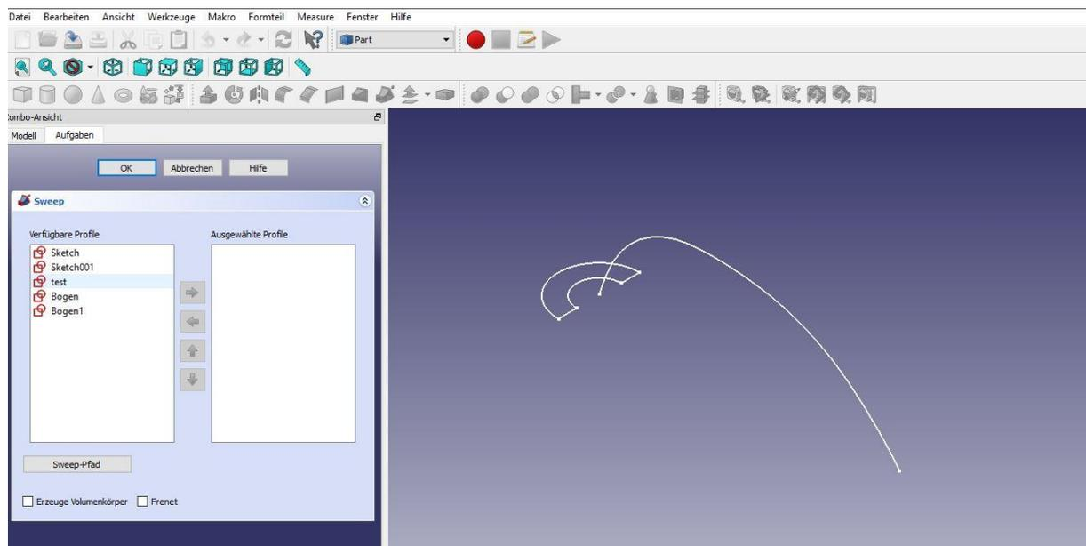
10 In Part --Sweep Werkzeug --Skizze Halbrundbogen auswählen—Erzeuge Volumenkörper ankreuzen—Im Server Pfad Skizze Punkt4 auswählen.
