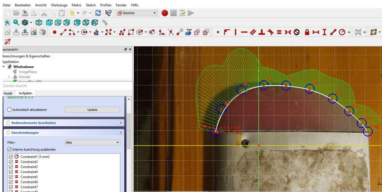
4: Foto vom intakten Endstück in FreeCad Image importieren und in Verbindung mit Sketcher skalieren und wieder mit B-Spline zeichnen.
