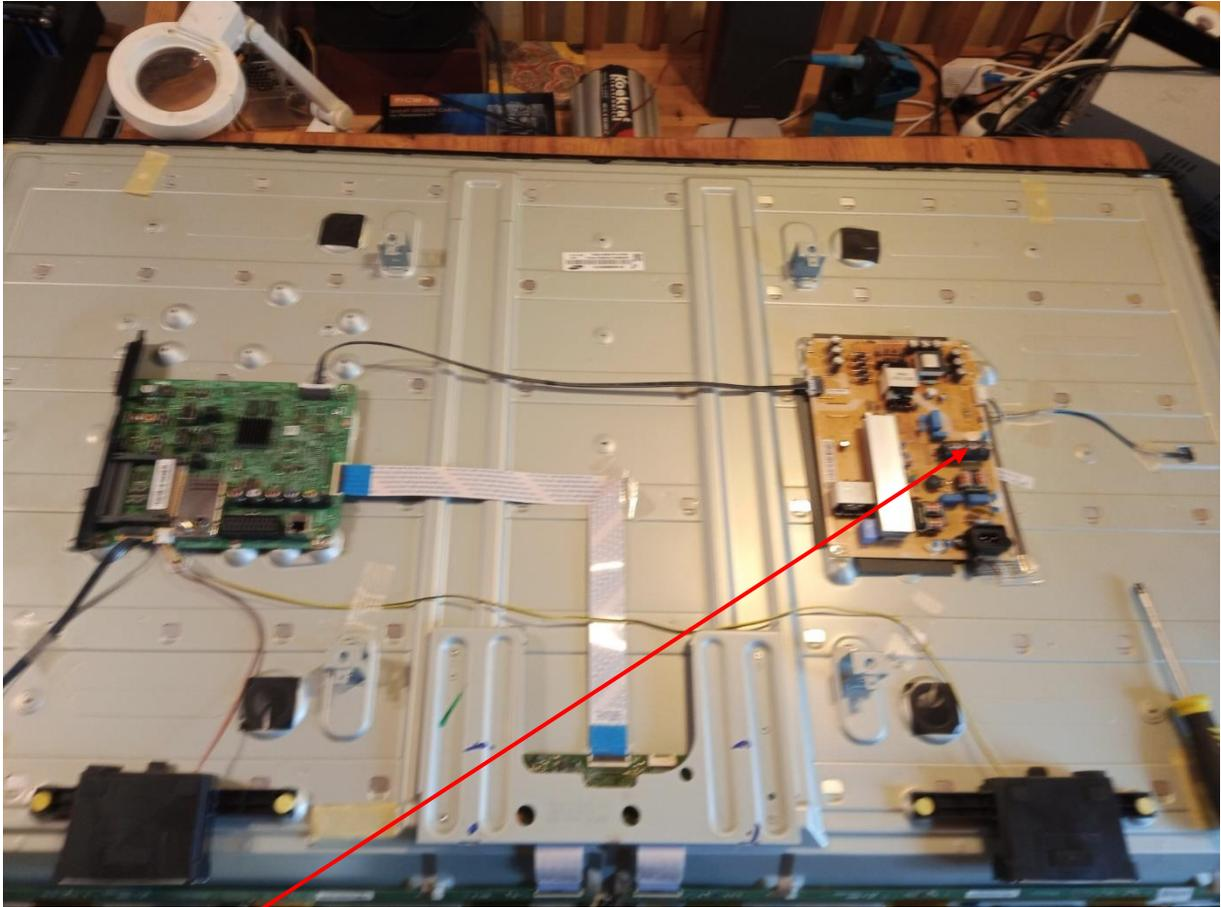
Beim Netzteil hatte der Hochvolt Kondensator seine 320Volt. Der Primärabschnitt mit den Netzdioden war in Ordnung.
