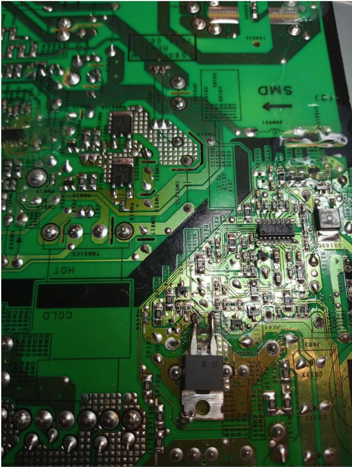
Auf der Rückseite des Netzteils hatte im Sekundärbereich des Netzteils ein Power SMD-Mosfet einen Kurzschluss und wurde durch einen Mosfet IRF740 ersetzt, der auch die Spannungs- und Stromwerte hat.
