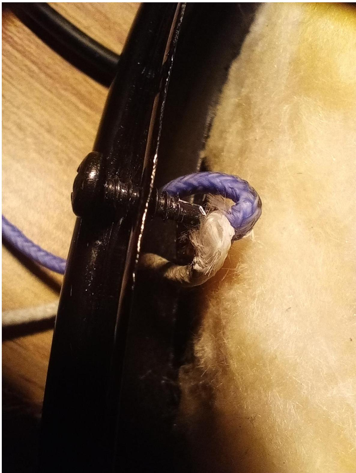
Anschluss des Heizelements so weit zurückgebogen, dass der Schrauben nicht mehr ansteht. Funktioniert wieder einwandfrei.
