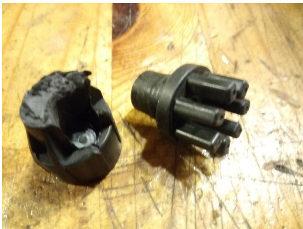
Das linke Teil ist durchgeschmolzen
