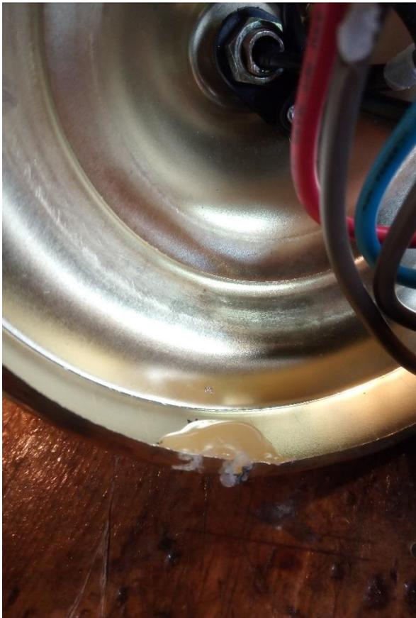
Beim Zusammenbau, Heissklebewulste, bei den Nietenplätzen angebracht
