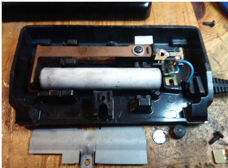
In diesem Keramikrohr sind Graphitplättchen und der ohmsche Widerstand wird kleiner, wenn sie zusammengepresst werden und die Nähmaschine schneller wird. Fehlende Plättchen die herausgefallen ergänzt und den fehlenden Platz mit Beilagscheiben aufgefüllt. Den Vordruck und die Nullstellung und die Position der Graphit Endstücke eingestellt.
