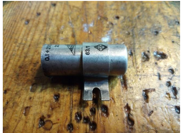
Der defekte Kondensator
