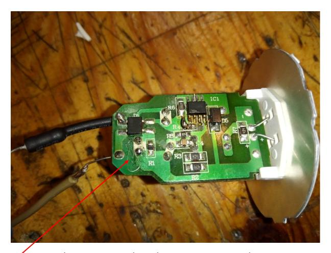
Mit einer dünnen Litze als Sicherungsersatz an der Printrückseite eingelötet. Beim Zusammenbau die Anschlüsse am Fassungsmittelkontakt und Hals (wie Reparaturanleitung 2 beschrieben) herstellen. Wandler und Ledplatine einbauen und die Plastikkugel verkleben.
