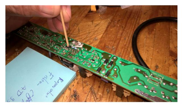
Einlöten des SMD Steuer IC mit Hilfe eines angeklebten Zahnstochers und einer selbstgebastelten SMD Lötspitze für meinen Lötkolben.
