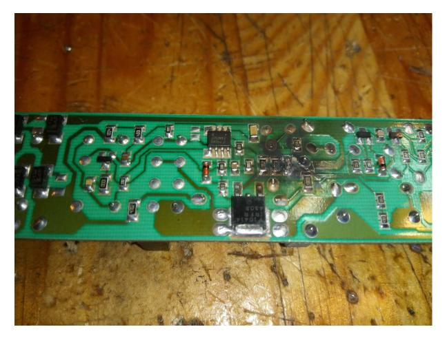
Beim Deckenfluter war einer der beiden Helvar Vorschaltgeräte 2 x 55Watt defekt. Der Kurzschluss des Mosfet IRFR 430b riss 3 Sms Wid 10hm plus den Steuer IC Fan 7527 mit. Die Bauteile kosteten nicht viel nur der Steuer IC benötigte mehr als einen Monat bis er von China zum Solarstüberl eingelangt ist.
