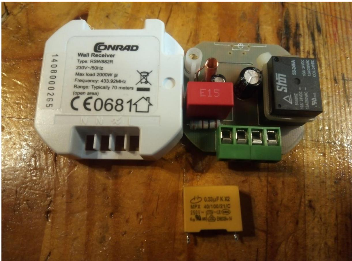
Abhilfe: Der gelbe Kondensator hatte statt 330nF nur mehr 160nF. Die Betriebsspannung für die Elektronik (ca12V) wird über diesen Kondensator und einer Zenerdiode von der Netzspannung gewonnen. Hier wird der Blindstrom des Kondensators ausgenützt (keine Verlustwärme). Nachteil ist, wenn kein schöner Sinus vorhanden ist, da ändern sich schlagartig die Stromwerte.
