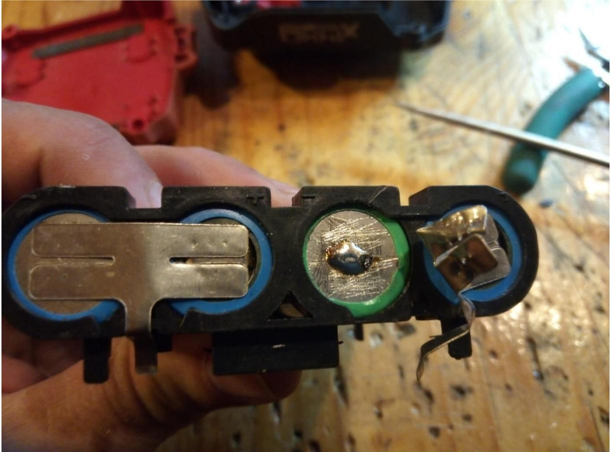
! Mit starken Lötkolben 80 Watt nur kurz löten vorher die Lötunkte verzinnen
