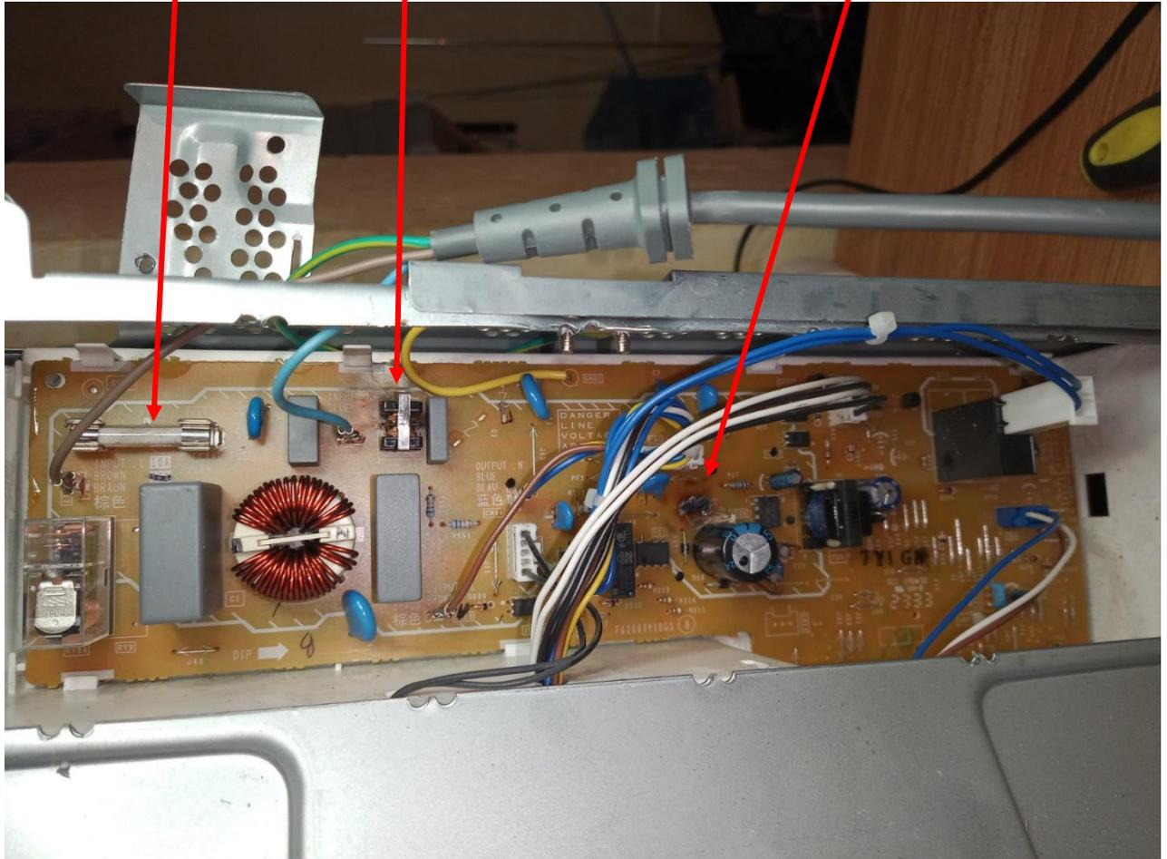
Auf der Rückseite die rep. Printplattensicherung
