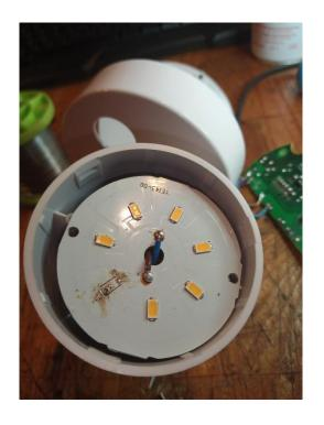
Defekte Led ausgelötet.
