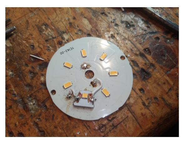
Das ausgeschnittene Ledsegment am Platz der defekt Led aufgeklebt (2K Kleber) und verdrahtet.
