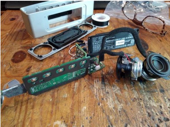
Akku bestellt und Gerät zerlegt und neuen Akku eingebaut, trotzdem blinkt beim Laden die rote Led und keine Ladung messbar.
